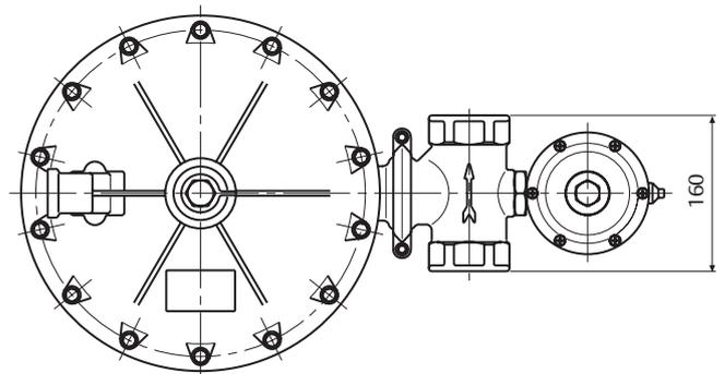
Nota: L'apparecchiatura può essere installata con orientamento dell'attuatore sia orizzontale sia verticale.
